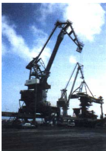
Figure 37 – Grue kangourou Caillard 900 t · m, grue quadricable Caillard 300 t · m et trémie associée, déchargeur à chaîne Buhler Caillard 1 000 t/h. Port de Lorient
