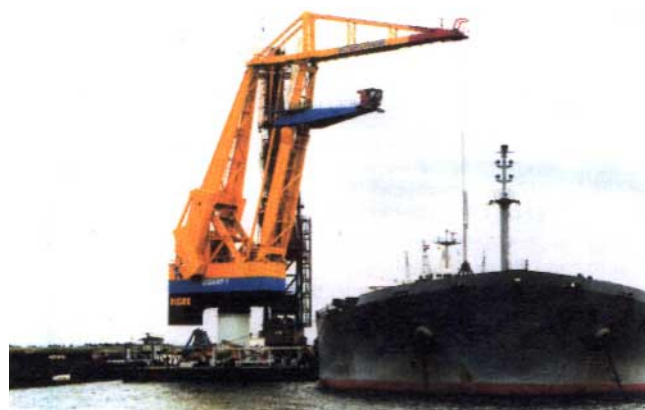
Figure 40 – Ponton-grue à benne FIGEE 1 500 t · m (36 t à 43 m). Port de Rotterdam
