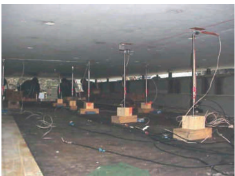
(c) capteurs de déplacement LVDT
