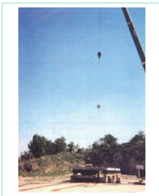
Figure 5 – Chute du bloc au cours de l'essai T2
