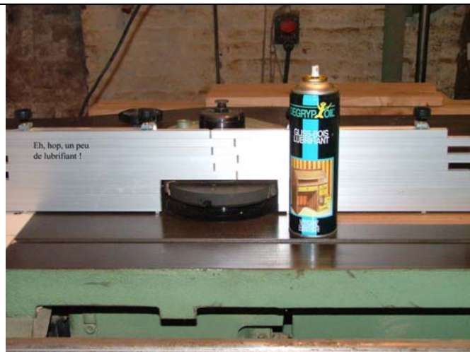
Photo 5: lubrification : un peu de lubrifiant sur les tables ne peut nuire à l'entraînement.
