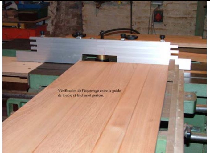
Photo 4: réglage chariot: lorsque les panneaux sont de grande dimension, il est souhaitable de les maintenir en utilisant le chariot mobile mais il faut s'assurer de l'équerrage entre le chariot et le guide d'usinage.
