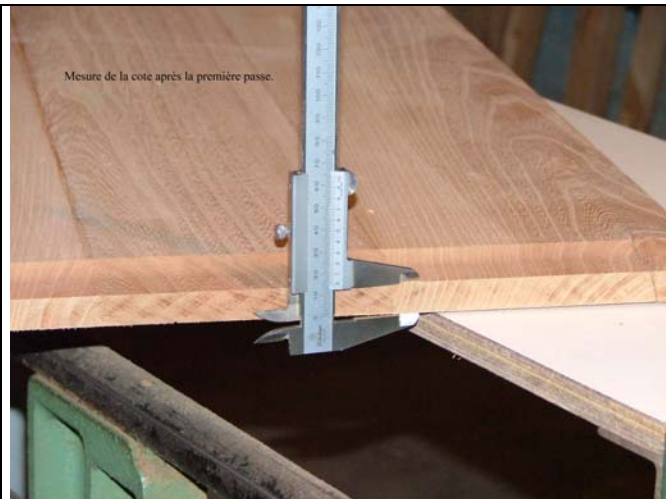
Photo 7: contrôle: après une première passe d'essai, on mesure la cote à l'aide d'un pied à coulisse et on rectifie...
