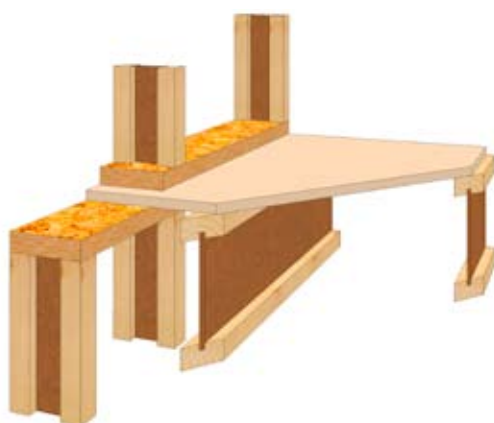
F9 Jonction dalle de plancher/mur
