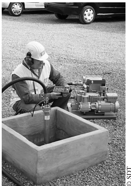
Figure 8 : Contrôle d'une cuve enterrée
