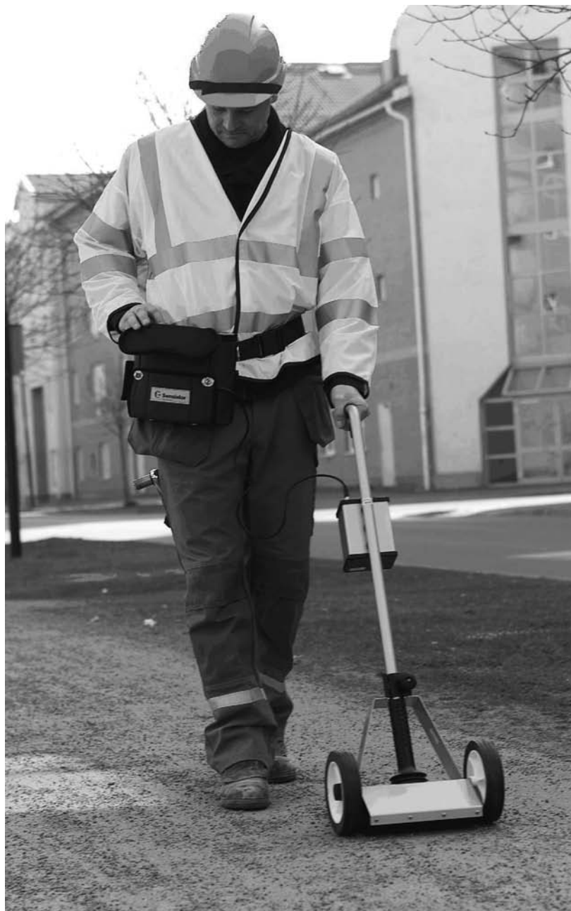
Figure 4 : Localisation de fuites sur réseaux enterrés
