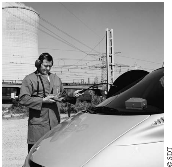
Figure 6 : Contrôle d'étanchéité habitacle véhicule
