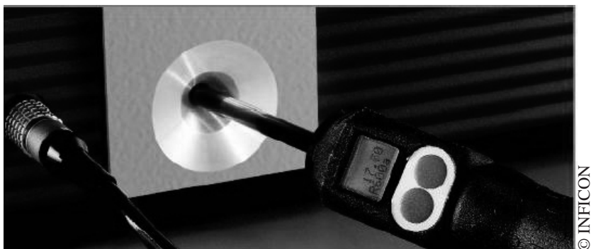
Figure 25 : Utilisation d'une fuite calibrée intégrée en reniflage
