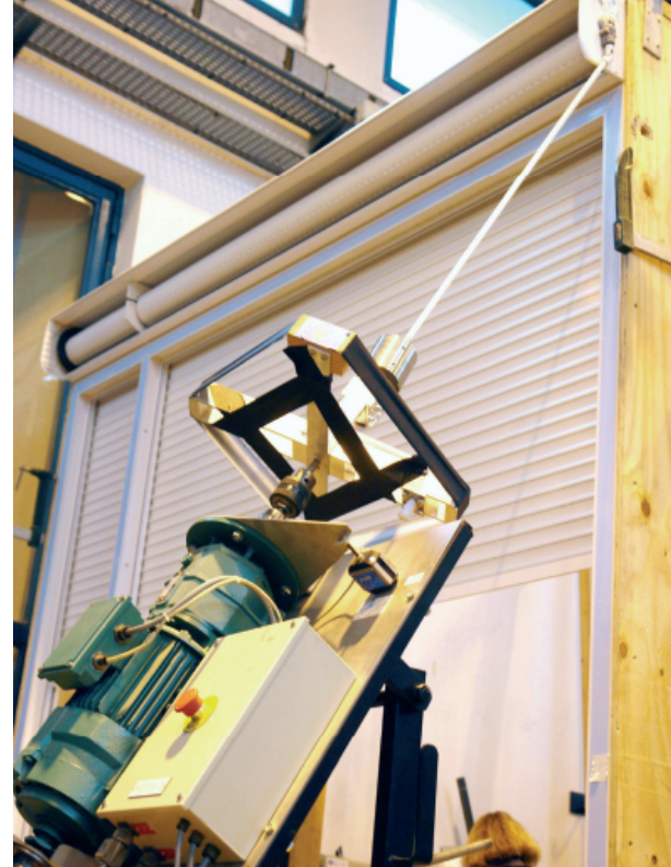
⌘ Banc d'endurance mécanique : les volets sont soumis à des cycles de repliement-dépliage (7 000, 10 000 ou 14 000) équivalents à plusieurs années d'utilisation.
