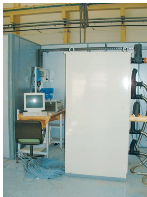
^ Machine à absorption pour rafraîchissement solaire
