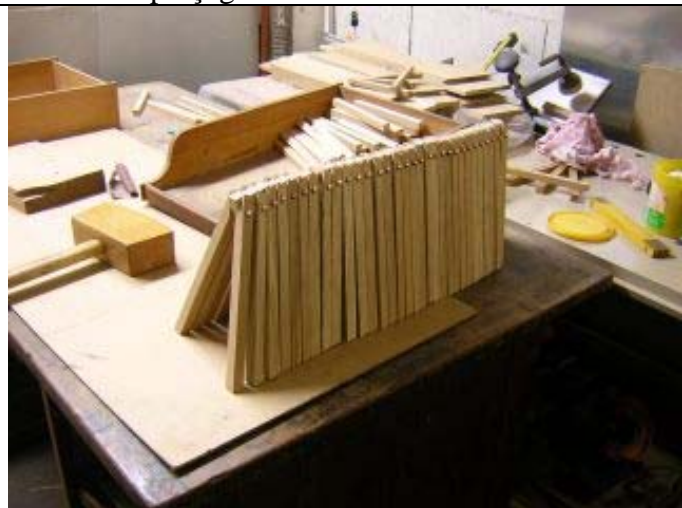
clous en place pour bloquer la rotation du tourillon
