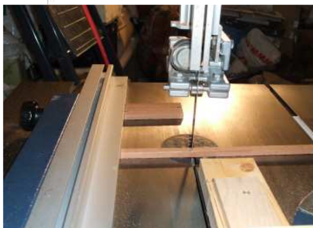
Mise à longueur des carrelets de 8mm
