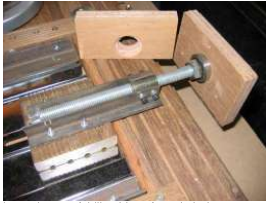
Le roulement à billes bloqué par le bois procure une commande pratiquement sans jeu.
