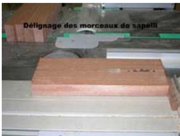
Délignage des morceaux de Sapelli
