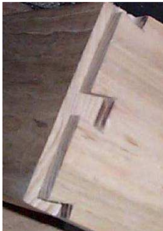
Queues d'aronde recouvertes
