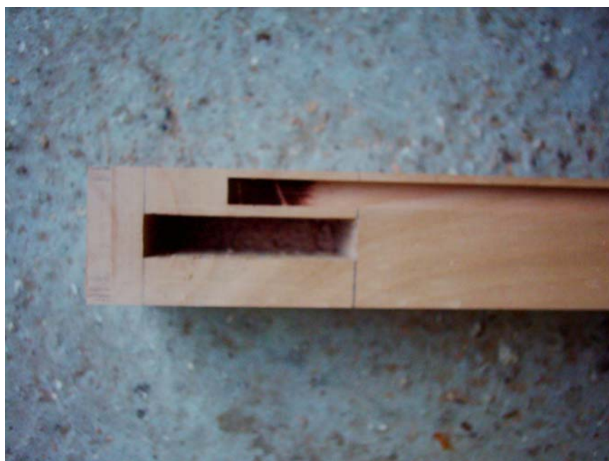
Figure 3 Montant avec mortaise et rainure pour accueillir le panneau
