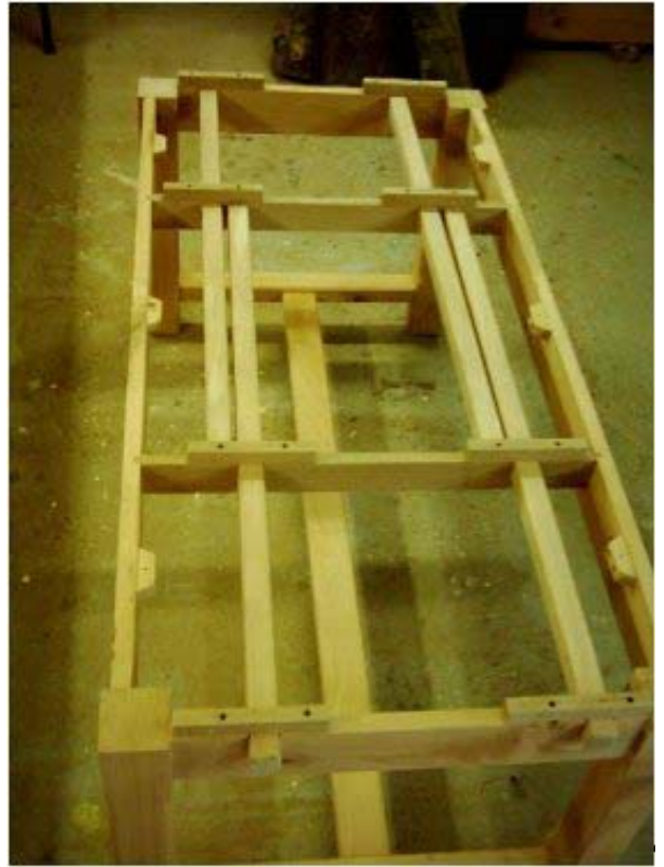
Figure 6 Mécanisme de support des allonges
