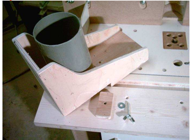
Le chariot avec son système de blocage
