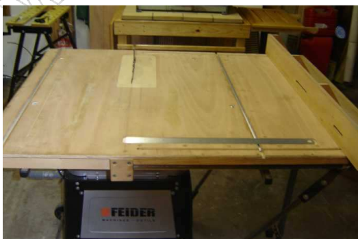
Ajout d'une règle pour mesurer directement la largeur de coupe entre la lame et le guide.
