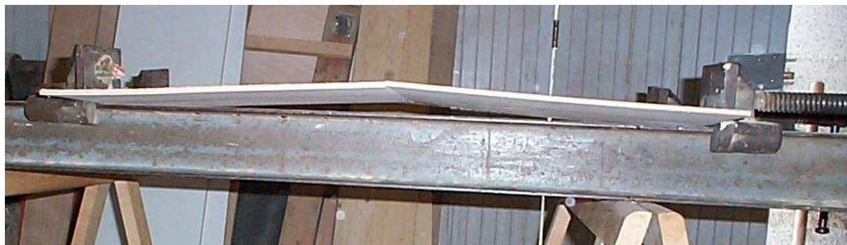
Utilisation d'un tasseau et de serre-joints pour éviter le flambage
