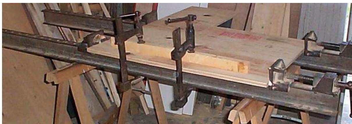
Utilisation d'un tasseau et de serre-joints pour éviter le flambage
