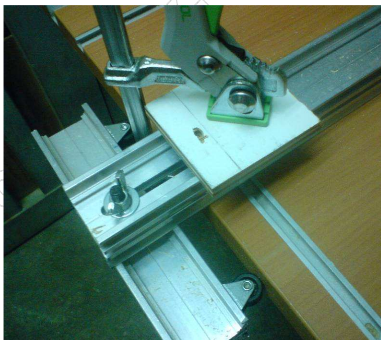
Figure 13 Bridage du guide parallèle
