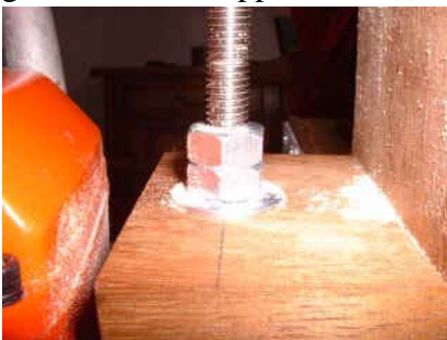
détail blocage : rondelle, écrou, contre-écrou
