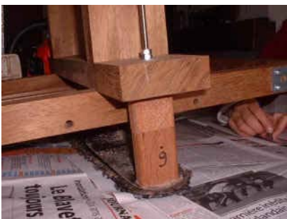
manchon de réglage d'épaisseur autour de la tige filetée ; blocage sous le guide et sur le support
