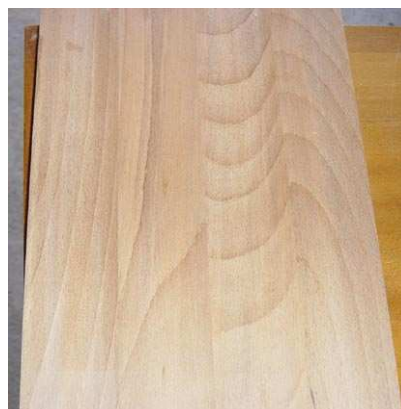
Panneau composé de 4 planches de 55x15x300
