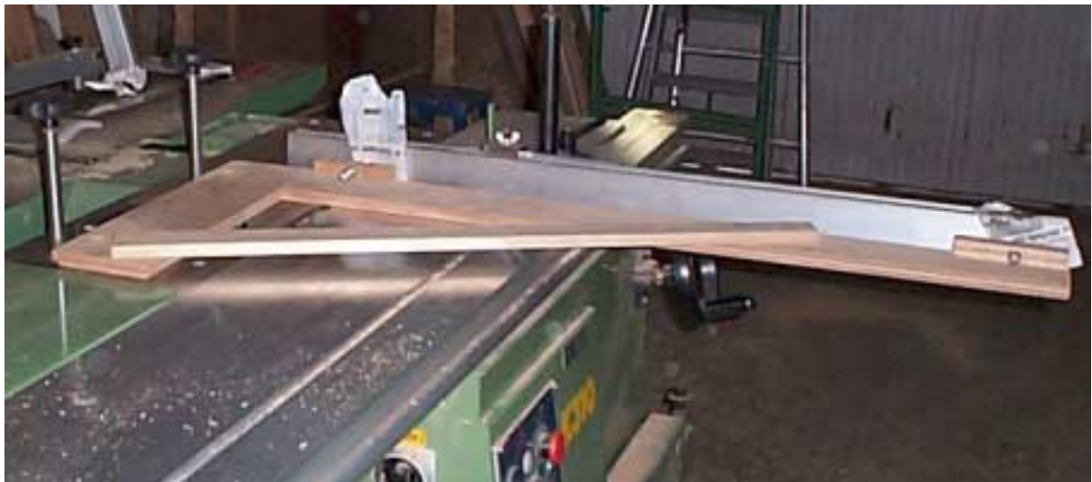
vue de l'équerre en position pour réglage du guide.
