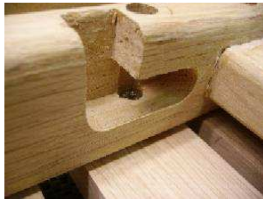
Vue du dessous avant ponçage définitif de la fixation du plateau à travers l'encoche.
