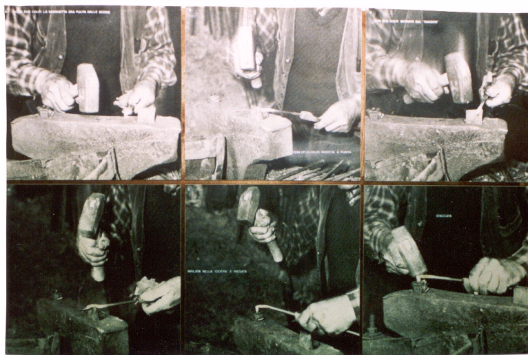
Photo 16: Les 6 étapes de la fabrication d'un clou forgé
