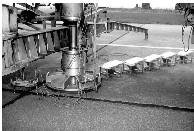
Figure 11 – Dispositif d'essai de plaque sur chaussée rigide
