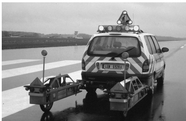
Figure 12 – IMAG (Instrument de mesure automatique de glissance)
