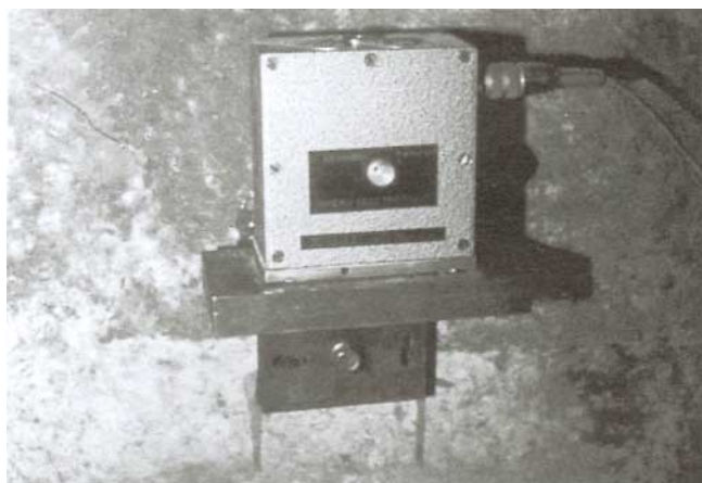
Figure 13 – Clinomètre fixé sur l'âme d'un pont-caisson (Photo LCPC)
