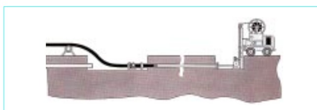
Figure 35 – Chemisage par tube préformé (d'après document Sade)
