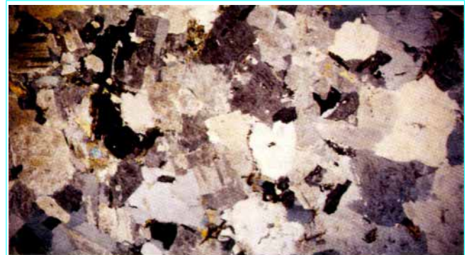
Figure 3 – Lame mince, vue en lumière polarisée, dans le granite du Hinglé (photo LCPC)
