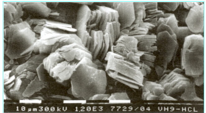
Figure 4 – Cristaux de kaolinite empilés en feuillets, vus au microscope électronique à balayage
