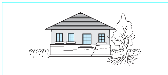
Figure 24 – Désordres partiels dus à l'action localisée d'un arbre, (source CEBTP 1991 [88] d'après [73])
