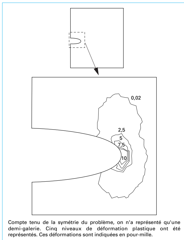
Figure 8 – Galerie elliptique en milieu élasto-plastique (progiciel de calcul par éléments finis CESAR-LCPC)
