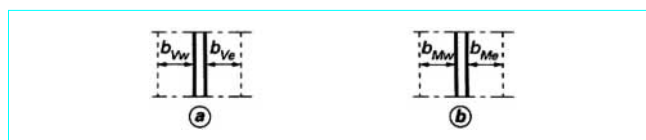
Figure 9 – Définition des largeurs des bandes de dalle à considérer pour le calcul des efforts tranchants (a) ou des moments de flexion (b) dans les poutrelles et dans les poutres
