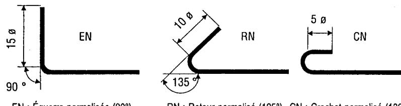
EN : Équerre normalisée (90°) RN : Retour normalisé (135°) CN : Crochet normalisé (180°)
