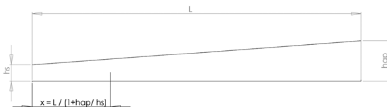
Schéma 43 : les contraintes \sigma_{m,o,d} et \sigma_{m,\alpha,d} sont maximales au point x = L/(1 + h_{ap}/h_s)
