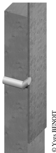
Schéma 84 : rupture de la tige
