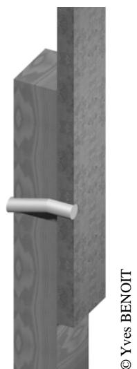
Schéma 86 : rupture de la tige
