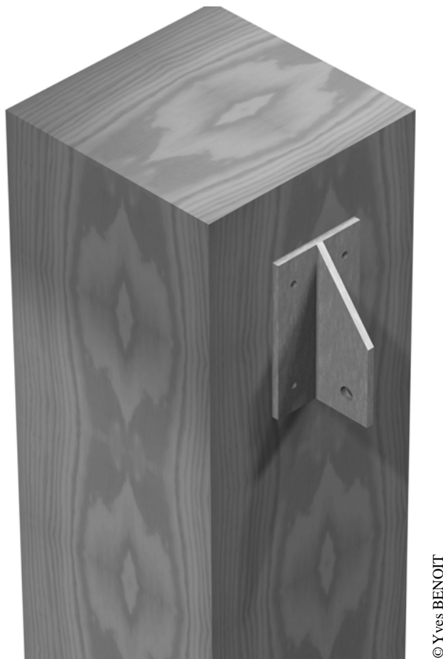
Schéma 70 : ferrure vissée sur un poteau, recevant des barres de contreventement
