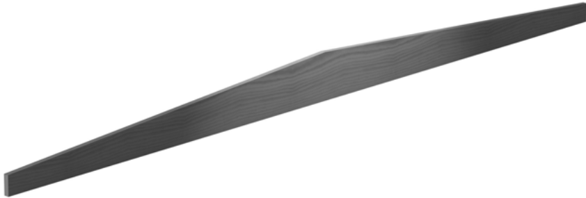
Schéma 45 : poutre intrados courbe à inertie variable
