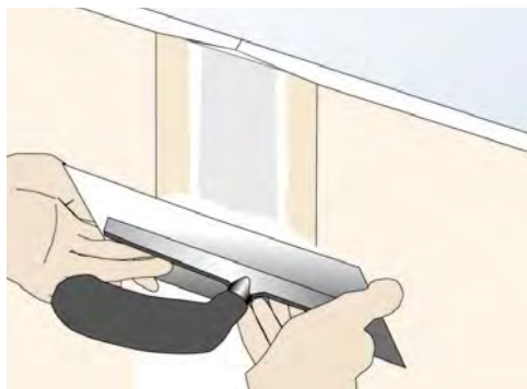
5 - Après le séchage, comblez d'enduit la zone amincie des plaques, au moyen d'un platoir.
