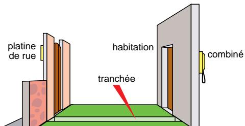
Mesurer précisément la distance de câble nécessaire entre l'emplacement du combiné et la platine de rue.
