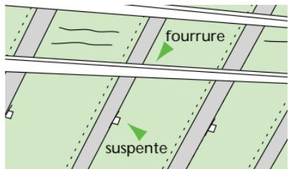
Clipser les fourrures sur les suspentes, puis visser les plaques de plâtre.
