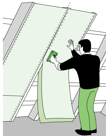
1 Disposer des bandes d'isolant (pare-vapeur vers vous) entre les chevrons, en commençant par le haut et en partant d'un angle.
