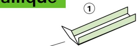
2 Fixer les rails avec des chevilles et des vis auto-perçantes tous les 60 cm environ. A l'aplomb du rail bas, placer le rail au plafond et visser.
