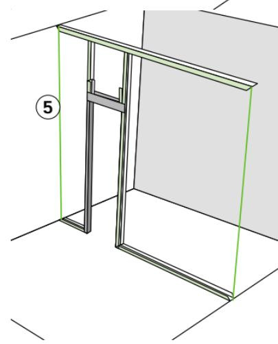
5 Mettre en place le deuxième rail vertical le long du bâti de la porte et dans les rails haut et bas. Le visser.
