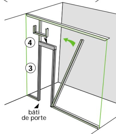
4 Placer sur la traverse haute de la porte un rail à l'horizontal avec 2 remontées de 15 à 20 cm d'équerre. Le visser sur le premier rail vertical sur le bâti.
