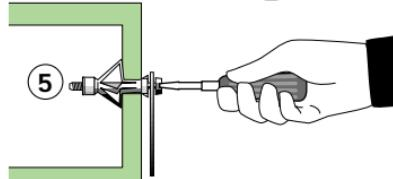
**5** La cheville étant expander, démonter la vis, positionner l'objet à fixer.
