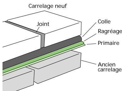
Nettoyer le carrelage à l'aspirateur et lessiver avec une lessive alcaline (type St Marc). Piquer l'ancien carrelage s'il est très lisse.
