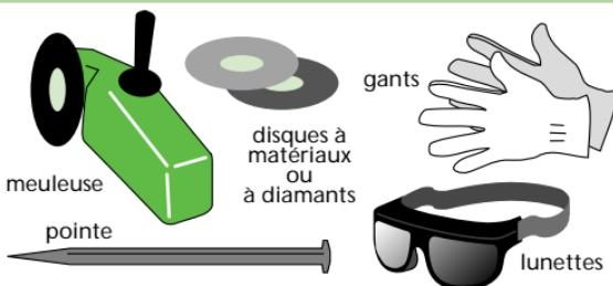
Les découpes de dalles sont tracées avec une pointe et réalisées avec une meuleuse équipée d'un disque à matériaux ou diamants.
