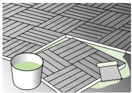
**Pose collée** : les lames sont collées directement sur un sol plan, sec et propre.
