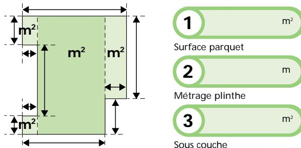
**Recommendation** : pour les découpes diverses, prévoyez 10% de parquet en plus dans le cas d'une pose en diagonale et 4% pour une pose droite.
