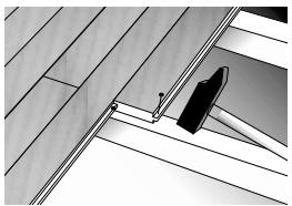
**Pose clouée** : les lames sont clouées sur des solives ou lambourdes. La fixation se fait avec des pointes dans les languettes.
