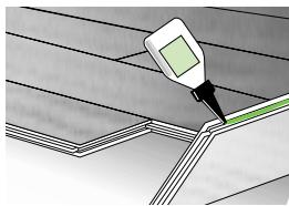
**Pose flottante** : les lames sont collées entre elles. La pose est non solidaire du support (sur une sous-couche).
