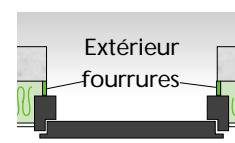
Relevez l'épaisseur totale de l'isolant (plaque de plâtre + isolant) pour définir la taille de la fourrure d'isolation nécessaire.
