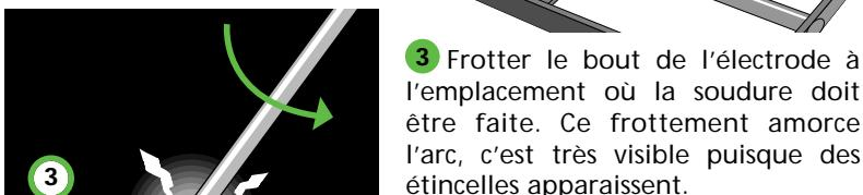
**3** Frotter le bout de l'électrode à l'emplacement où la soudure doit être faite. Ce frottement amorce l'arc, c'est très visible puisque des étincelles apparaissent.
