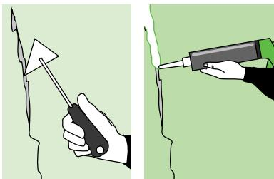
Il est nécessaire de poser un calicot pour stabiliser une fissure avant d'appliquer une peinture ou un crépi.
