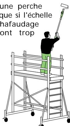
Dans le cas de murs de grande surface, n'arrêtez le travail que sur "un relief naturel" (un angle de mur ou une descente de gouttière) pour masquer la reprise.
