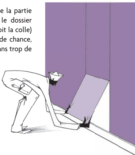
Arrachage d'un revêtement strippable.
