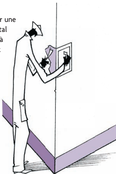
Réparation d'un angle à l'aide d'une lisseuse.
