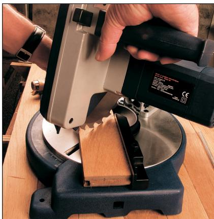
**5** Une scie à onglet électrique aide à la précision de la coupe. Coupez un peu "long" pour permettre des ajustements éventuels. Vous terminerez par une coupe droite plus facile à exécuter.
