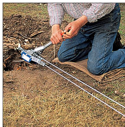
**5** Réunissez par un tire-fond le bout de la chaîne d'ancrage et celle qui ceinture la souche. Agissez sur le levier du treuil à cliquet : progressivement, la souche émerge de terre.
