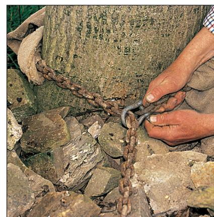
**4** Ici, la base d'un gros noyer va servir de point d'ancrage. Choisissez une chaîne suffisamment longue et résistante. Ceinturez l'arbre protégé et fermez la boucle par une manille.
