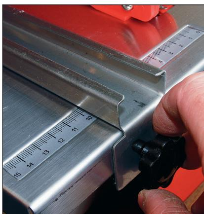
**3 Des règles millimétriques à chaque extrémité de la table et des molettes de blocage permettent un positionnement précis du guide, qui doit être rigoureusement parallèle au disque.**
