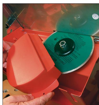
**8 Le disque est aisément accessible après démontage des deux vis de fixation du carter de protection. Deux clés fournies avec la machine permettent de démonter les écrous de blocage.**
