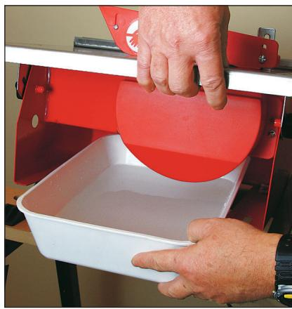
**2** Glissez le bac à eau sous le carter de coupe en basculant légèrement la machine. Pour éviter les débordements, complétez le remplissage une fois que le récipient est en place.
