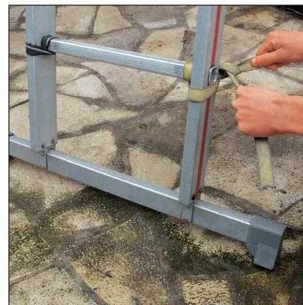
**6** Même avec des patins antidérapants en caoutchouc, les sols lisses augmentent les risques d'accident par glissade du pied de l'échelle. Là encore, arrimez les montants en haut comme en bas.
