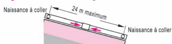
Fig. 38 : Gouttière de longueur > 12 m
