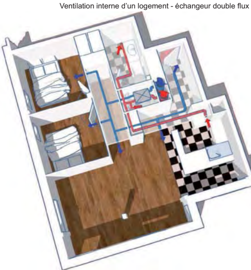
Ventilation interne d'un logement - échangeur double flux
